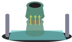
② ①と同じサイズのアクリル板をモルタルの中心に載せる
