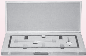
KC-202 平面度検査器(曲げ型枠用)
