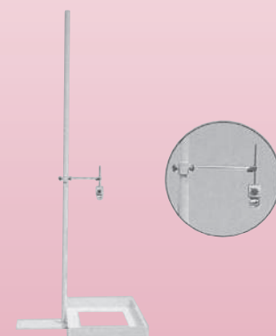
KC-278 建築用ボード類の衝撃試験機
