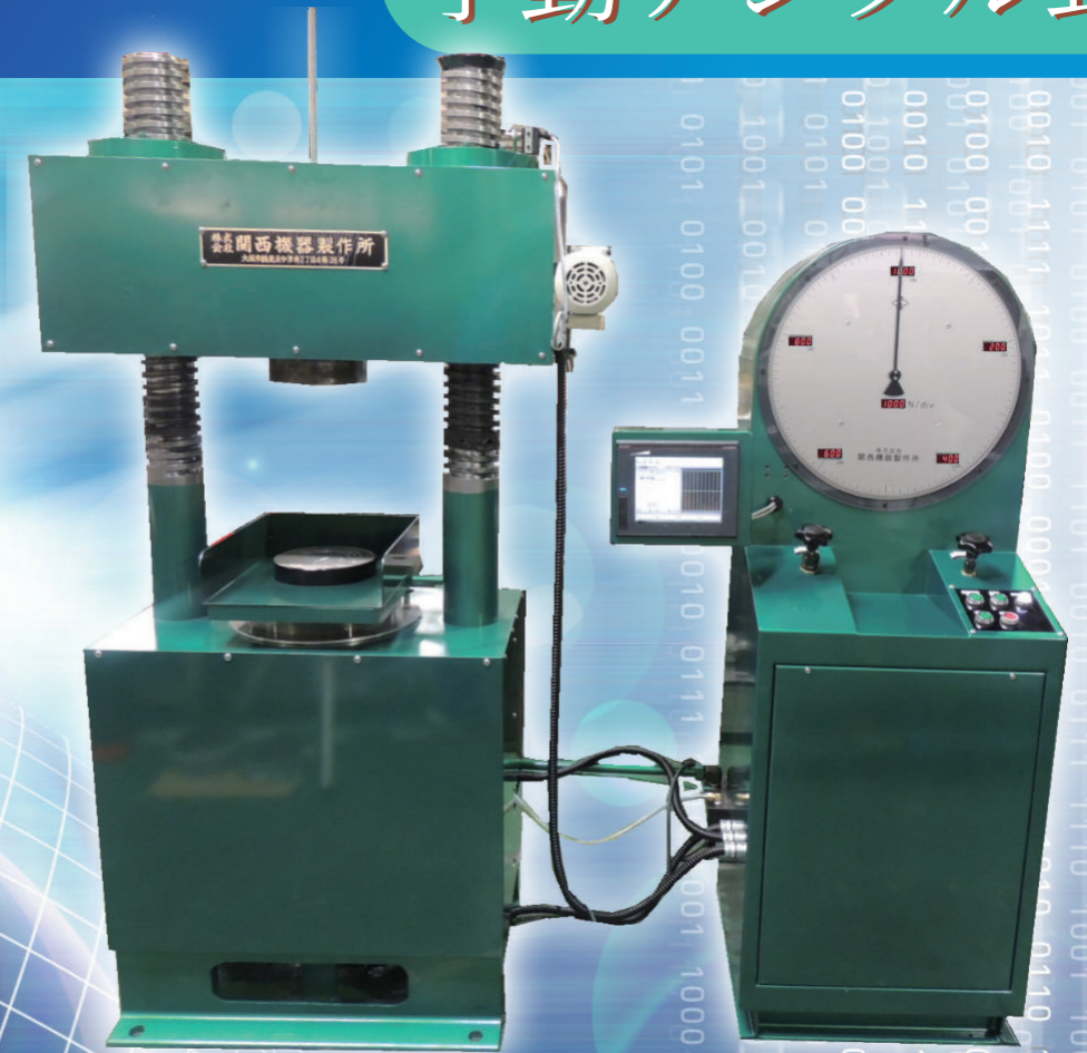
※画像は能力 2000kN 圧縮試験機
